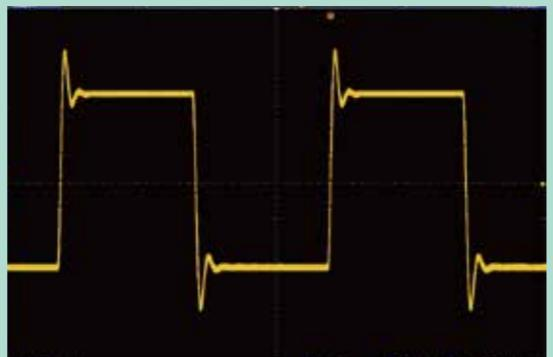
パラメタ可変波形として内蔵の2次LPF波形を用いて、オーバシュートとリンギングのある方形波を容易に作成。
