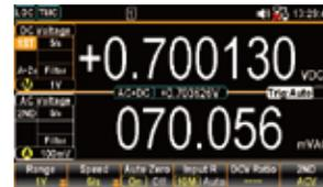
デュアル測定 (DC 電圧・AC 電圧)
