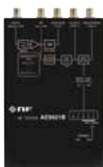
AEテスタは、プリアンプ、フィルタ、ディスクリミネータ、レートメータの機能を小型ケースにまとめた簡易型AE計測器です。ハンディチェックとして便利です。
