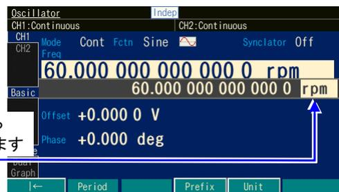
単位を Hz から rpm に変更します
