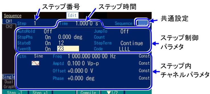
1ステップ分のステップ制御パラメタと1チャンネル分のステップ内チャンネルパラメタを同時に表示します。ステップ内チャンネルパラメタのチャンネルは、アクティブなチャンネル P.4-24 です。
