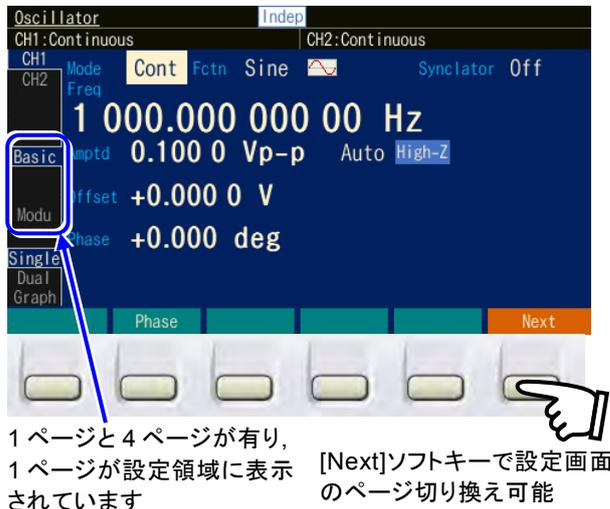
ページを切り換えるには[Next]ソフトキーを押します。又は、切り換えたいタブをモディファイノブや矢印キーで選択し、(ENTER) キーを押します。
