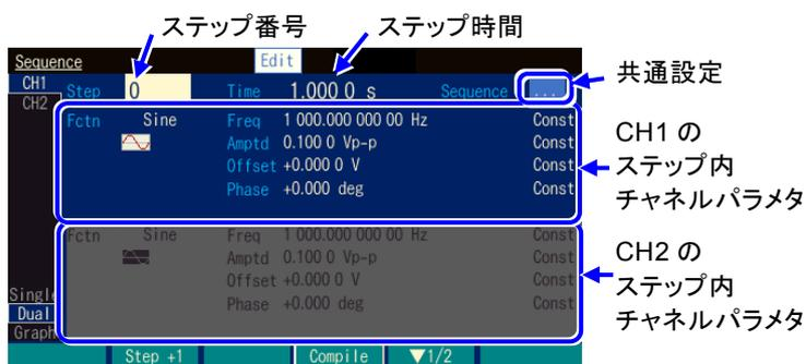
1ステップ分のステップ内チャンネルパラメタを2チャンネル同時に表示します。ステップ制御パラメタはステップ時間のみが表示されます。アクティブなチャンネル P.4-24 側のステップ内チャンネルパラメタが設定できます。
