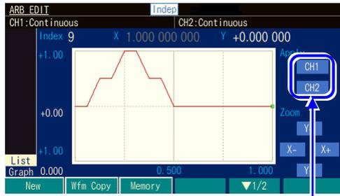
[CH1]か[CH2]を選択し ENTER で波形が出力されます, WF1983/WF1981 では[Apply]
