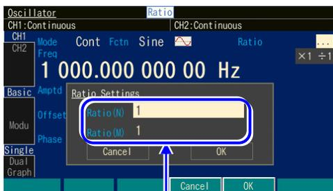
Ratio(N), Ratio(M)入力欄で比を設定
