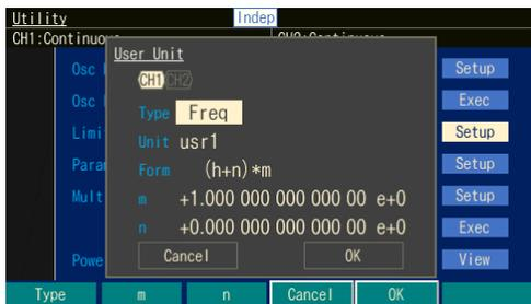
1. Type を選択(☞ P.4-14)します。[Type]ソフトキーが使えます。周波数の単位を換算するため Freq に設定(☞ P.4-18)します。Form を選択(☞ P.4-14)し、(h+n)\*m に設定(☞ P.4-18)します。
