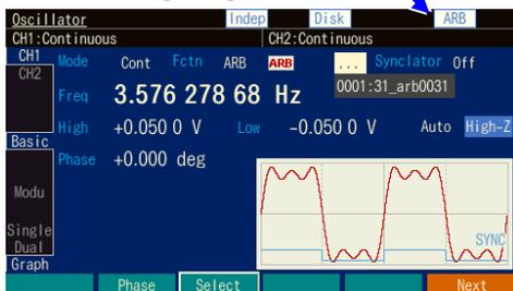
1. 波形を任意波形: ARB に設定すると、振幅設定範囲アイコン **ARB** の右横に[...]が現れます。この[...]を選択([P.4-14](#))すると、任意波形の選択画面に移ります。この項目では選択時、**(ENTER)** を押す前に現在選択されている任意波形名が表示されます。
