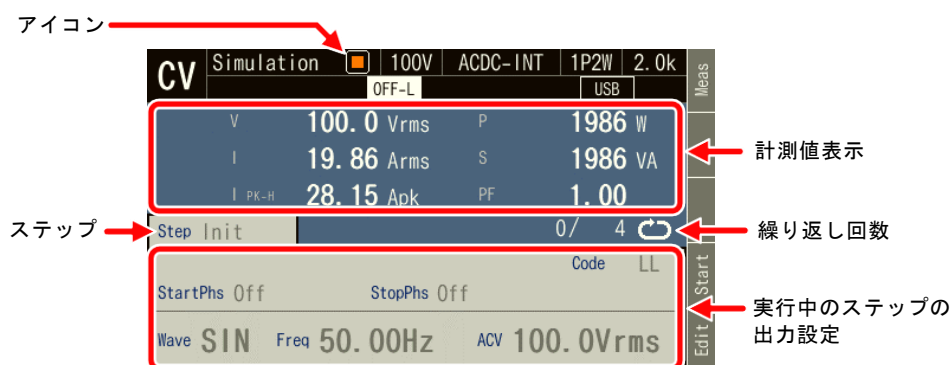
図 4-19 シミュレーション制御画面（出力オン状態・電源変動試験停止中）
