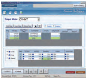
2 车载电装品测试类型例 (ISO/DIS7637-2.2 Pulse4) (仿真启动时过低电压情况)
