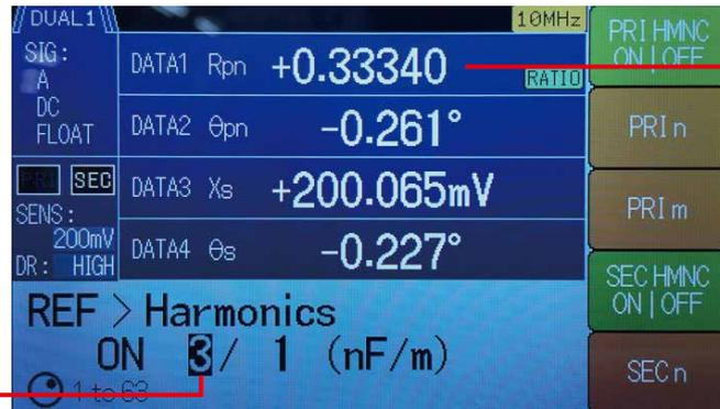
主検波器の分数調波の設定を、m=1に固定してnを2, 3, 4, ... とすると、2次、3次、4次の高調波成分を測定可能
