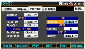
5. F5 (Enter) キーまたはノブキーを押してからノブキーをスクロールするか、+/- キーを押して、目的の USB プロトコルオプションに移動します。この例では USB CDC を選択しています。
