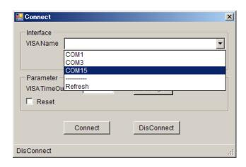
4. ホスト PC に設定したボーレートと同じボーレートを選択し、[Connect]ボタンをクリックして接続を確立します。
