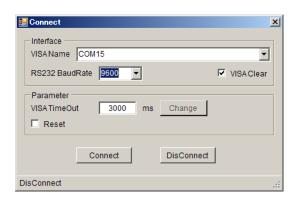
5. VISA TimeOut は、タイムアウトまでの時間を設定できます。設定した時間を超えても DM2571 の応答がない場合は、測定を停止します。下の図はデフォルトの 3000 ミリ 秒の設定で、最大設定は 60000 ミリ秒です。
