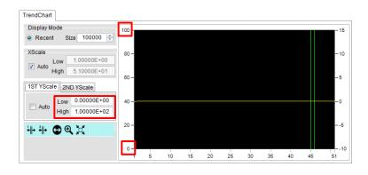
第 1, 第 2 ディスプレイトレンドチャートは、デュアル測定の表示も可能です。そのたの Y 軸設定 め、 Y 軸設定は、1ST YScale(第 1 ディスプレイ)と 2ND YScale(第 2 ディスプレイ)に分かれています。 2ND YScale の設定は、上記の 1ST YScale と同じです。以下の図を参照してください。赤い囲みは 1ST YScale の、オレンジの囲みは 2ND YScale の Y 軸を示します。
