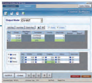
例2 車載電裝品測試類型例(ISO/DIS7637-2.2 Pulse4)（模擬啟動時過低電壓情況）
